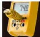
El termopar tipo K se conecta directamente al medidor (SC240/SC260)
